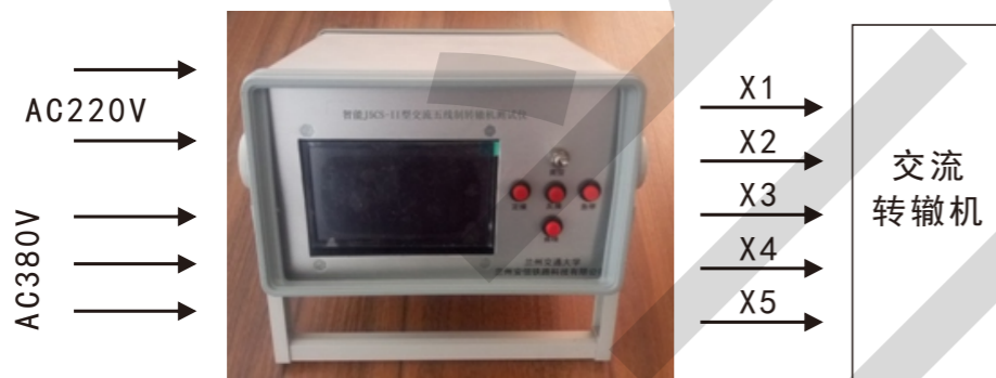
交流五线制转辙机测试仪连接示意图
