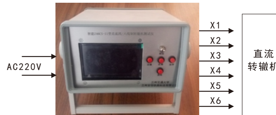
直流四/六线制转辙机测试仪连接示意图
