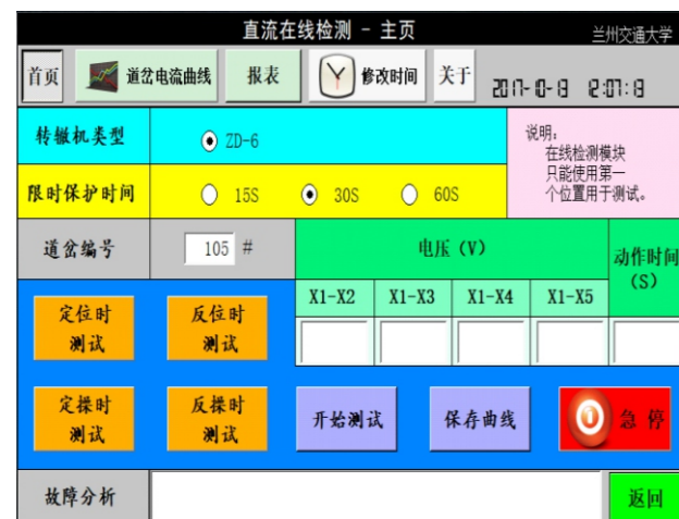
道岔控制电路智能测试分析仪测试画面
