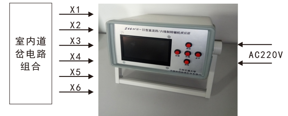
直流四/六制转辙机模拟箱连接示意图
